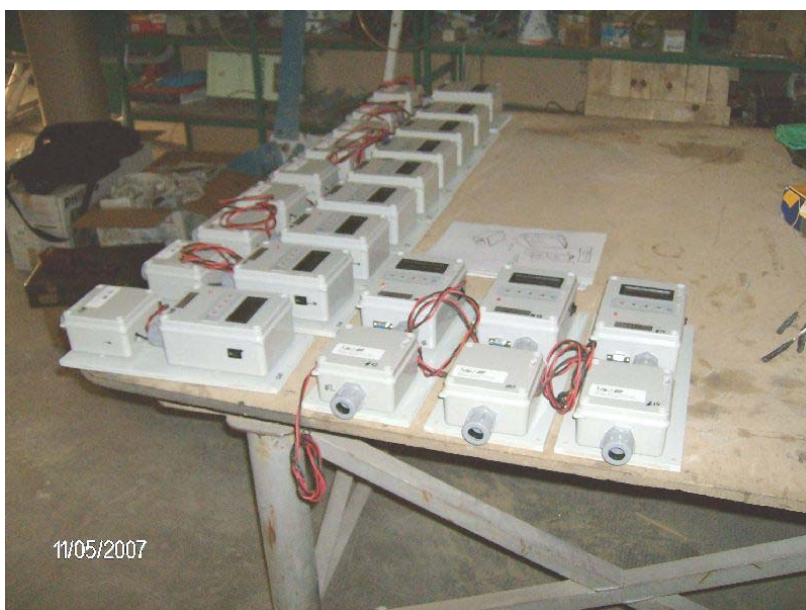
Figura 5.8 - Vista de los equipos entregados para medición de energía EM/12 - 11-05-2007
