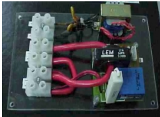
Figura 3: PCB-ACB2 en un circuito de sensado
