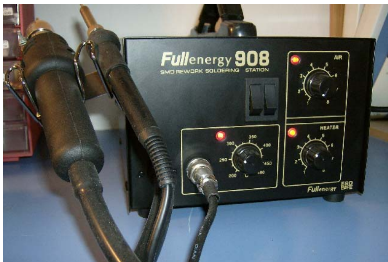
Figura 5.4 – Estación de Soldado Full Energy
