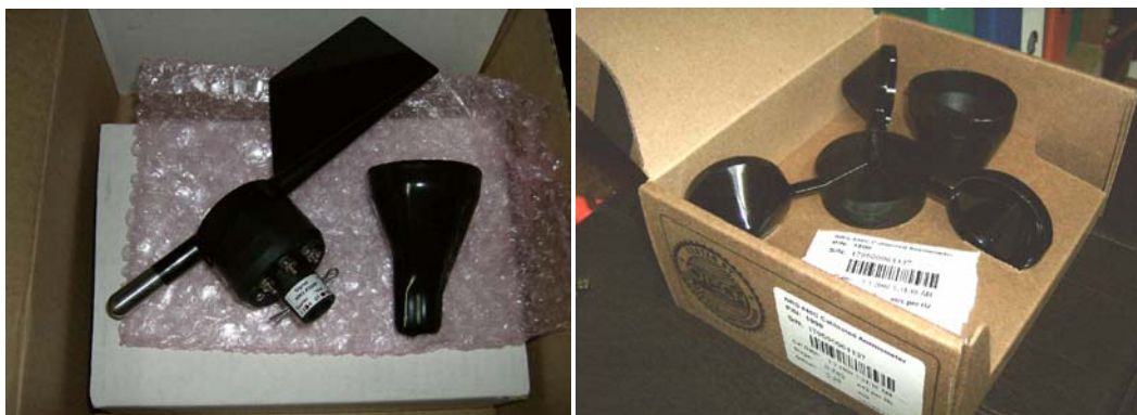
Figura 5.2 – Sensores NRG – Anemómetro y Veleta
