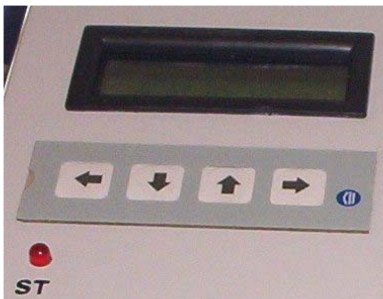
Figura 4.5 – Interfase de Teclado y Display EM12
