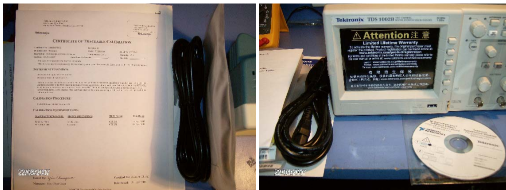
Figura 5.1 – Osciloscopio TEKtronix adquirido TDS1002B / 60MHz y certif de calibración
