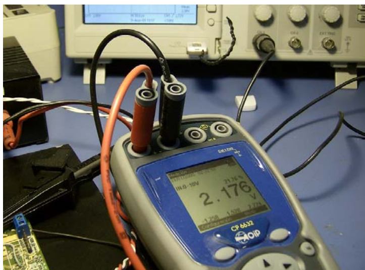
Figura 5.3 – Calibrador AOIP CP6632 en funcionamiento
